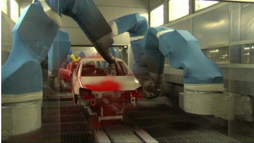
Ilustración 12. Proceso de pintura automatizado
