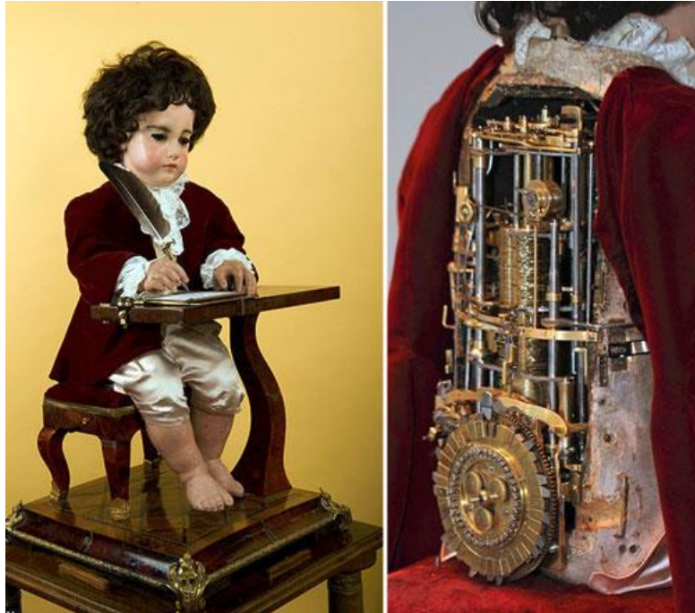
Ilustración 4: Autómata "El escritor" con mecanismo interno
