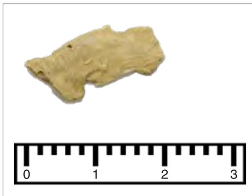
Figura 198 A y B. Columna 27 con empaste y muestra de 2 cm para analizar
