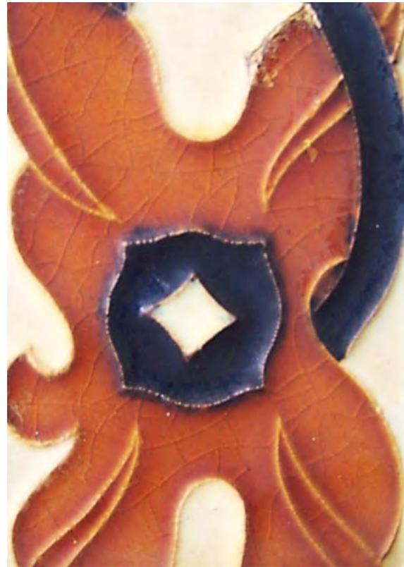
Figura 104 y 105. Detalles de los craquelados formados en la capa de vidriado
