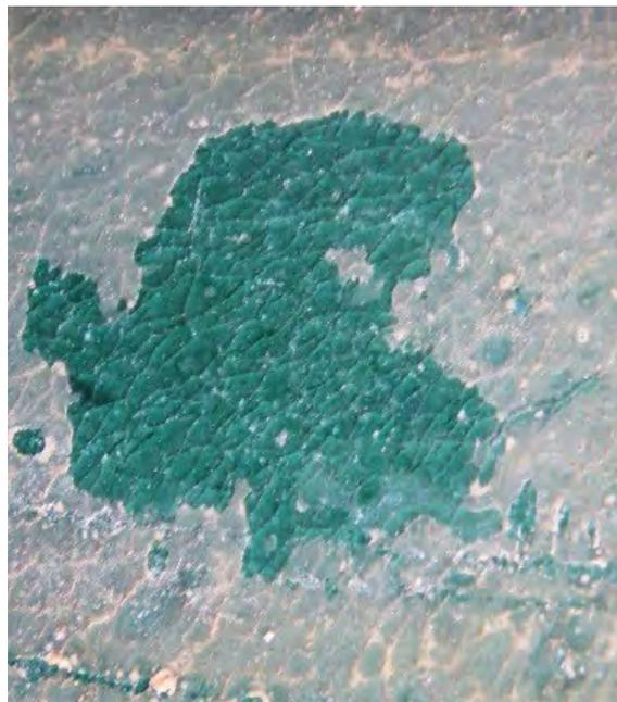
Figura 224 A y B. Detalle de eliminación mecánica de patinas
