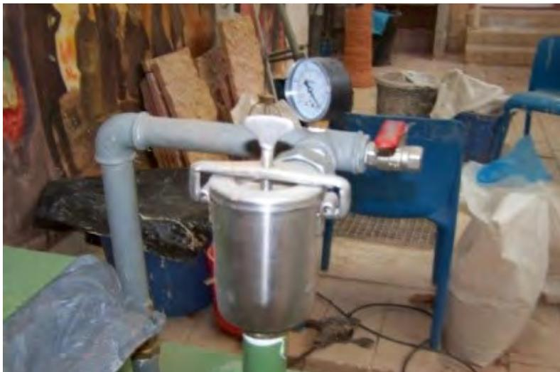
Figura 152 y 153. Máquina estrusionadora para compactar el barro y sacar las posibles burbujas de aire
