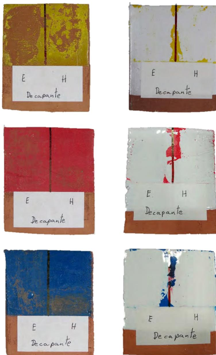
Figura 173, 174, 175, 176, 177 y 178. Catas de eliminación de tintas con disolventes orgánicos: Decapante Marca DECK 3000- exento de cloruro de metileno
