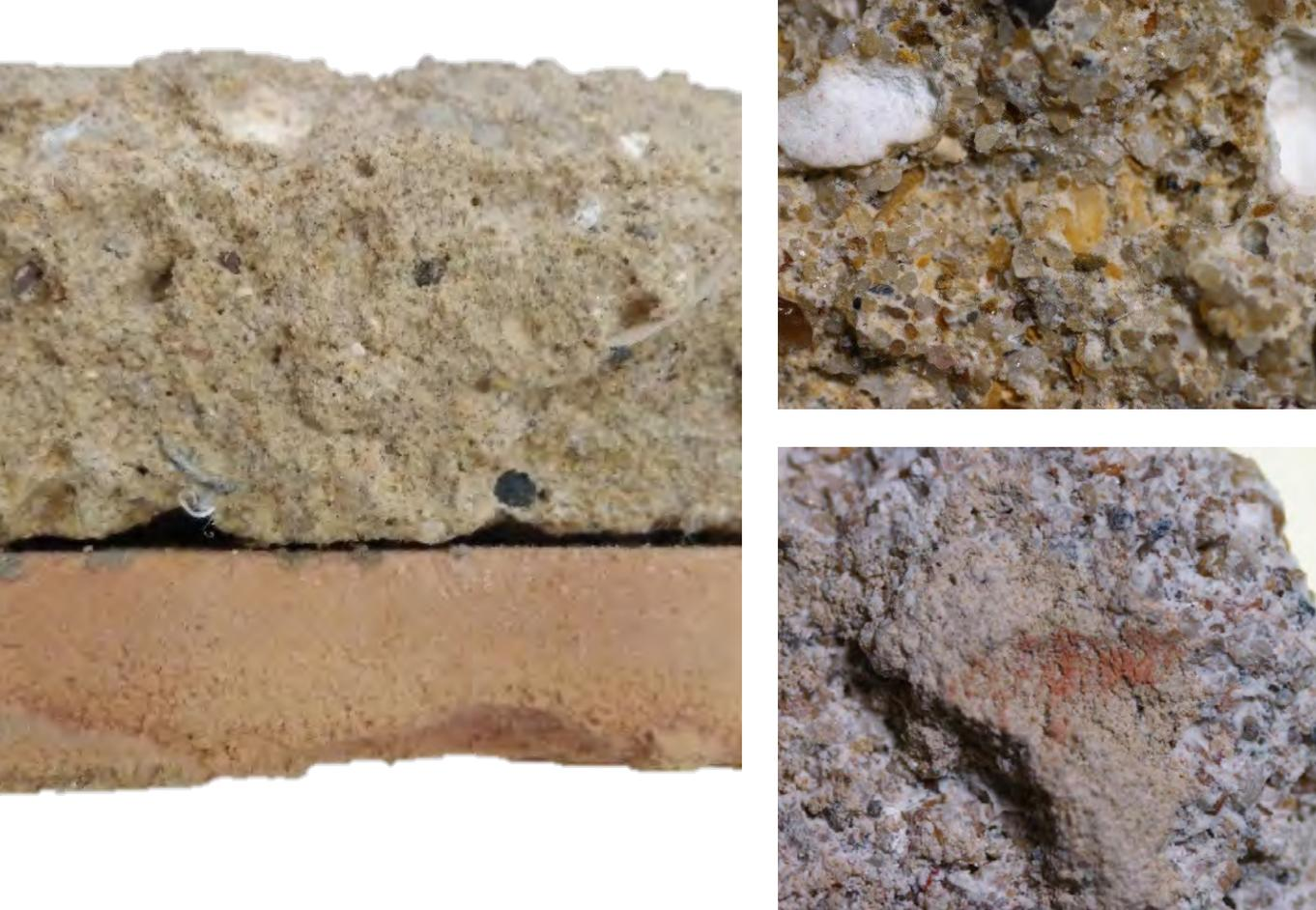
Figura 126. Sección de azulejo y mortero
