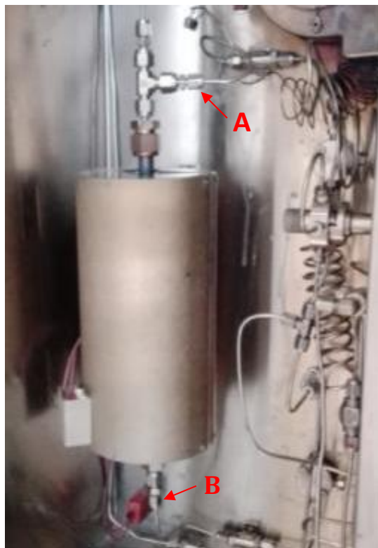
Irudia 14: Erreaktorearen muntaiian askatu beharreko azkoinak
