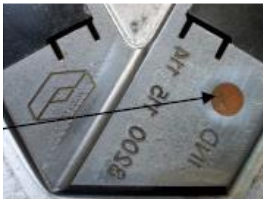
Figura 5.2.2.4. Postizo de cobre para el grabado de los índices de modificación.
