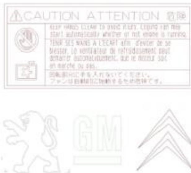
Figura 5.2.2.5. Marcajes de anagramas de cliente e indicaciones de seguridad.
