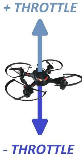
Figura 16. Throttle de un dron
