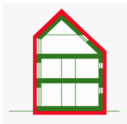
13. Irudia - Passivhaus isolamendu termikoaren irizpidea
