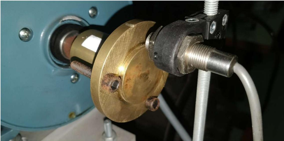
**Ilustración 41. Montaje provisional del sensor Hall**
