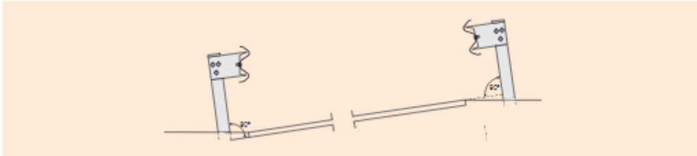
FIGURA 7.13: Inclinación de las barreras de seguridad.
