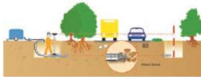
FIGURA 8.12: Excavación mediante topos.
