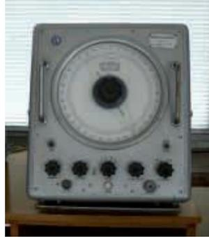
Figura 3.24 Radiogoniómetro RGX-1.
