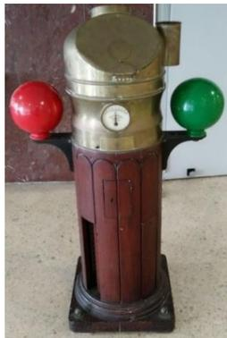
Figura 2.4 Aguja Magnética con sistemas de corrección incorporados.
