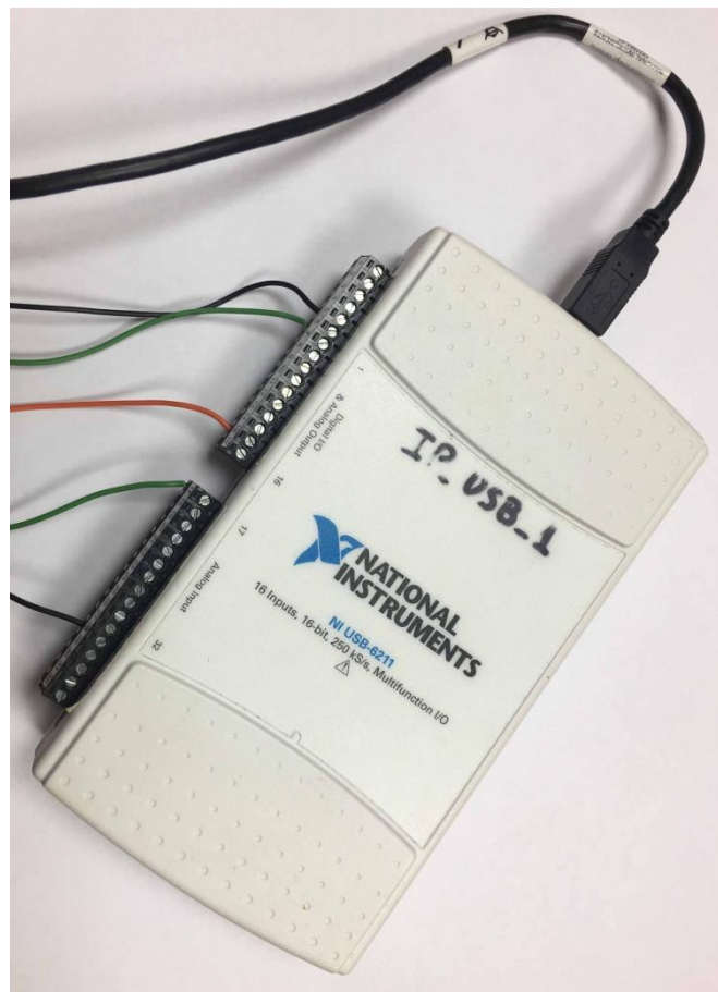
Figura 12: Tarjeta de adquisición USB6211 utilizada
