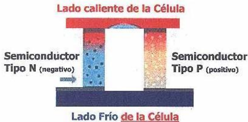
Figura 5: Esquema de funcionamiento célula peltier
