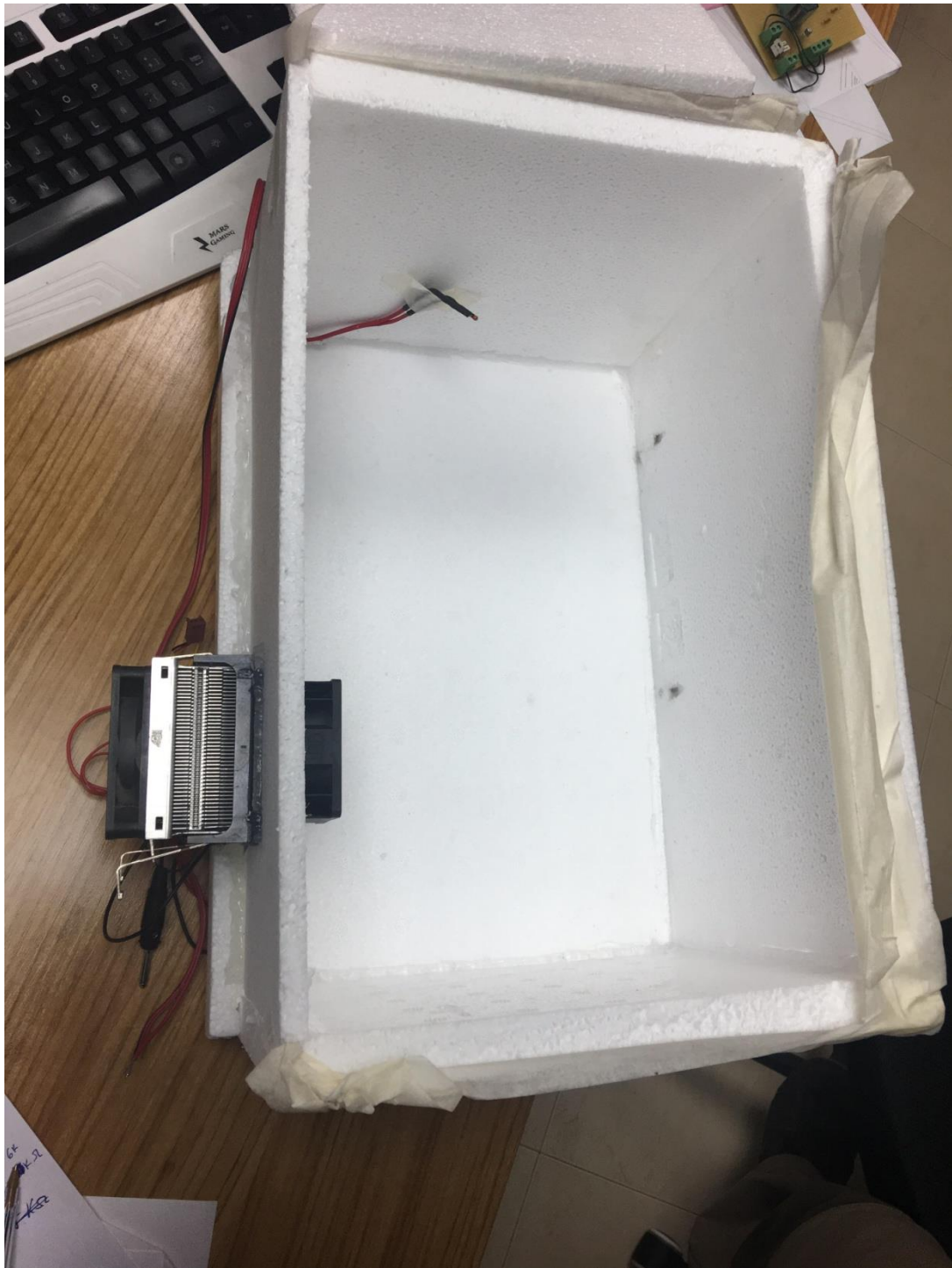
Figura 22: Cajón refrigerador y montaje radiador celda peltier
