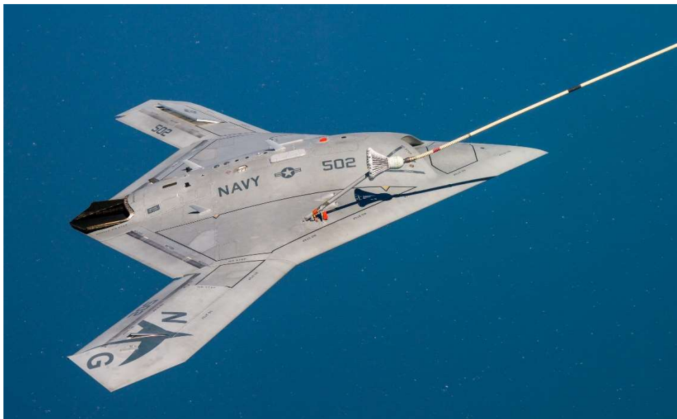
Ilustración 3. Repostaje en vuelo de UAV militar. (Fuente: Armada de los Estados Unidos)
