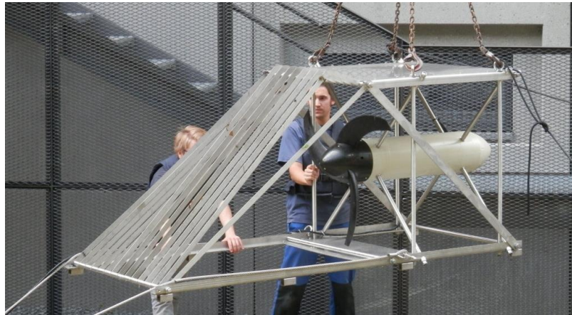
Ilustración 4.18: Ejemplo uso rejillas, empresa Smart Hydro (Alemania, Munich).
