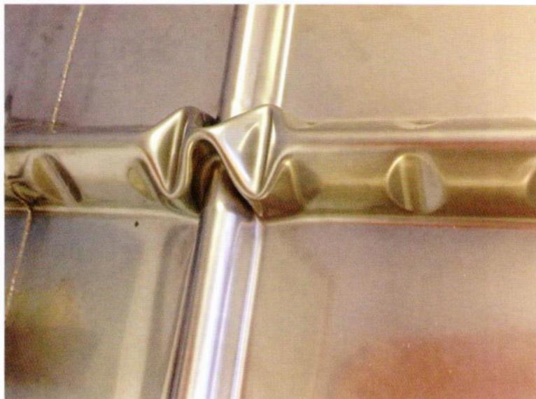
Fig.3 Ejemplo de corrugación en el interior de un tanque tipo MK III
