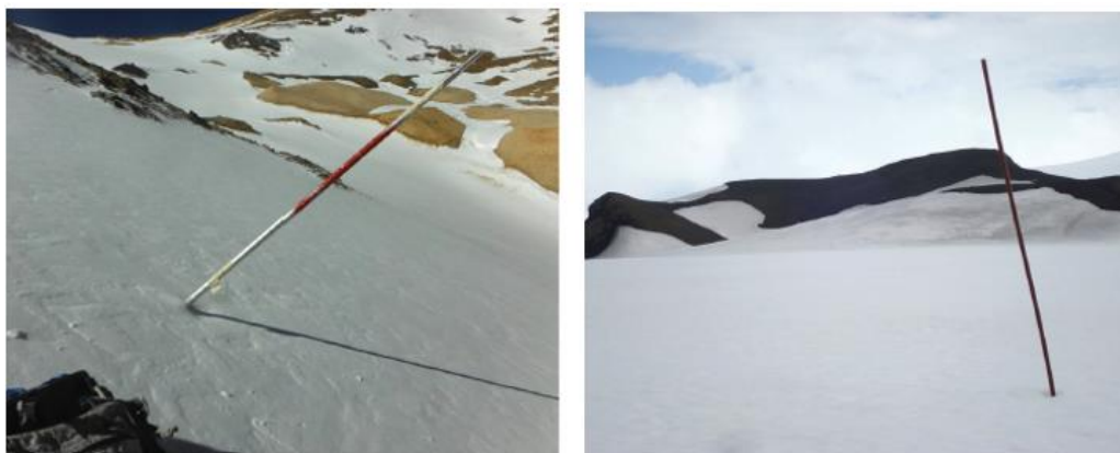
Figura 10. Sistema de balizas instaladas en un glaciar para su medición
