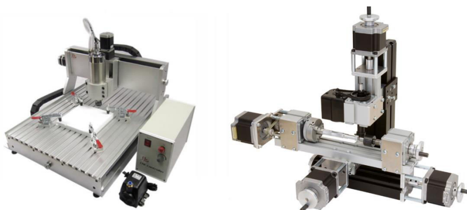
Figura 1.1. Fresadora de tres ejes (izquierda) y cuatro ejes (derecha).
