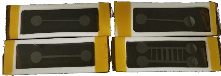
Figura 3.13: Molde de SU-8 con marcos de teflón sujetos con kapton.
