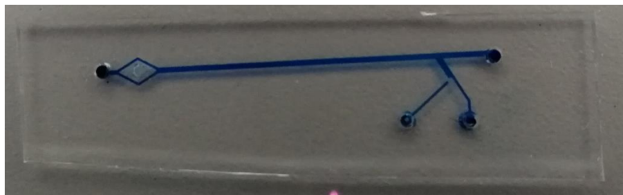
Figura 4.3: Prueba para ver si había fugas. La forma del canal pertenece al diseño de máscaras prestadas por Cristian Mendes perteneciente al departamento de Química y al BCMaterials para hacer la prueba antes de diseñar las nuestras.
