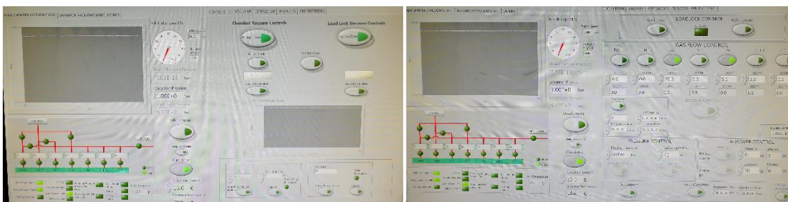
Figura 3.15: Ventanas del LabView que se utilizan para la creación del plasma en le RIE.
