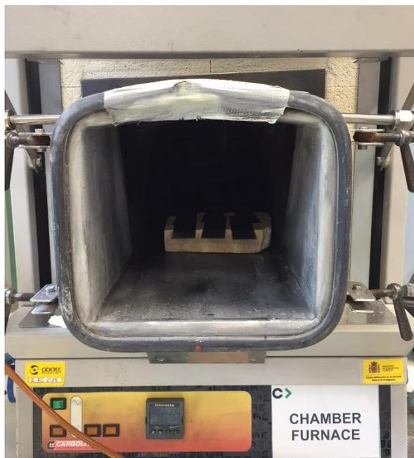
Figura 3.7.- Horno CWF 11/23 utilizado para aplicar el tratamiento térmico.
