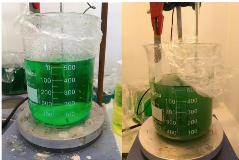
Figura 3.4.- A la izquierda el baño de níquel químico. A la derecha el baño de NiP con 0.4g/L partículas.
