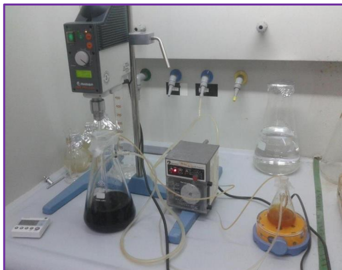
Figura 2.1: Montaje experimental empleado en el laboratorio para la síntesis de MNPs. El \text{N}_2 se burbujea en todo momento en las disoluciones de los cloruros de hierro y de \text{NH}_4\text{OH} . La bomba peristáltica añade gota a gota los cloruros sobre el \text{NH}_4\text{OH} , mientras esta disolución se agita mecánicamente. Tomado de Cruz-Izquierdo (2013).
