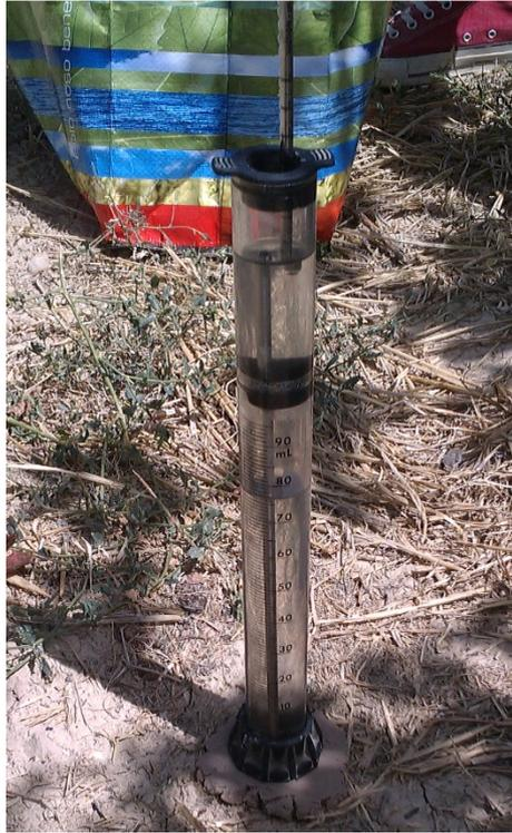
Figura 3.6. Infiltrómetro de minidisco en el momento de medida en el ensayo de Oion en el año 2012.
