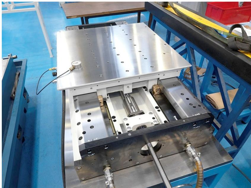
Figura 4-29 Imagen de un carro de rectificadora hidrostático.
