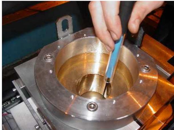
Figura 5-43 Comprobación del campo magnético generado en el interior del cojinete mediante un gaussmetro manual,
