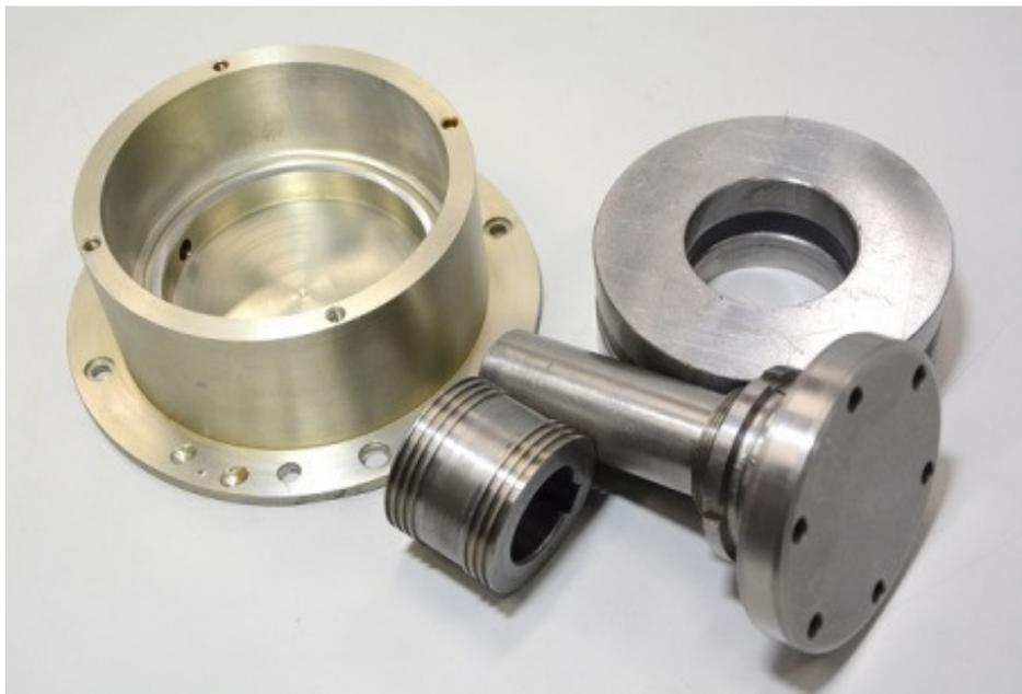
Figura 6-8 Imagen del conjunto de piezas que conforman la junta de estanqueidad.
