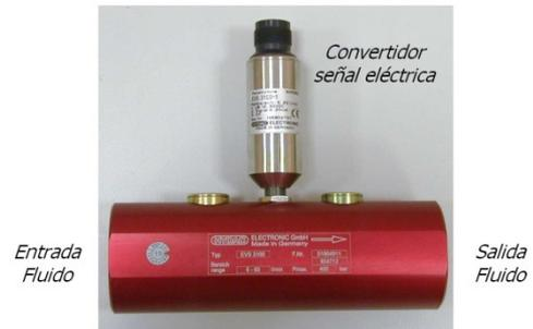
Figura 3-41 Sondas de presión y caudal utilizadas en los ensayos.
