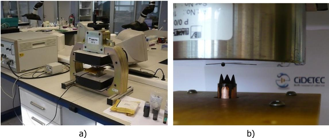
Figura 5-12 Equipo utilizado para la caracterización de los fluidos magnéticos, a) magnetómetro y equipos auxiliares de alimentación, y b) ferrofluido bajo campo magnético en el electroimán.
