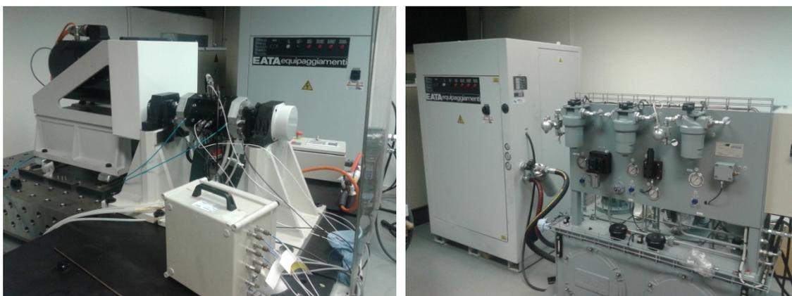
Figura 3-56 Banco de ensayos de cojinetes radiales, ensayos iniciales.
