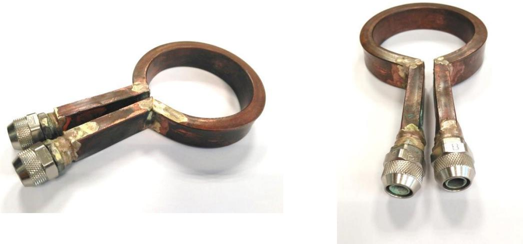
Figura 5-52 Imagen de detalle del anillo de refrigeración del cojinete híbrido activo, temperatura estabilizada con recirculación de agua corriente.
