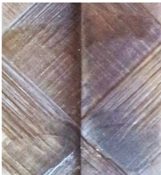
Figura 6-9 Superficies de propagación de grieta en laminados anti-simétricos.
