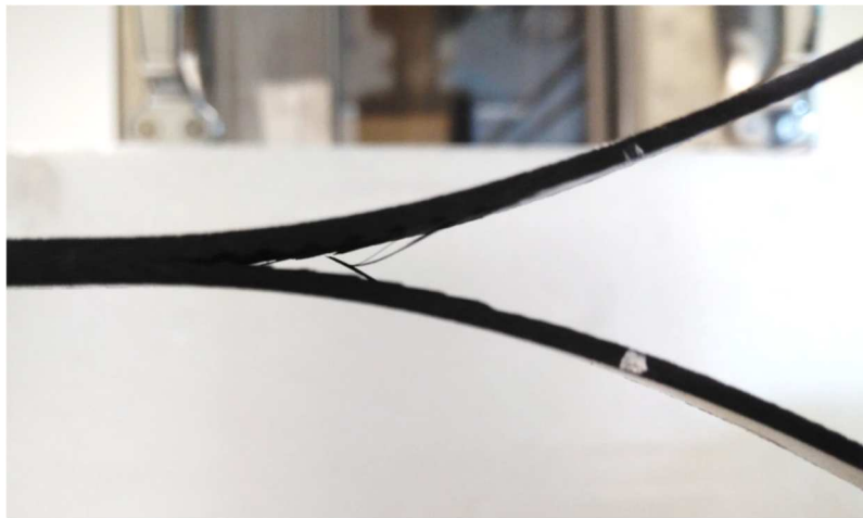
Figura 7-6 Fase de propagación de grieta.
