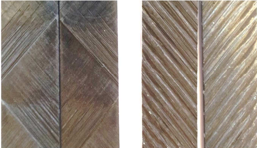
Figura 6-10 Superficies de propagación de grieta en laminados simétricos.
