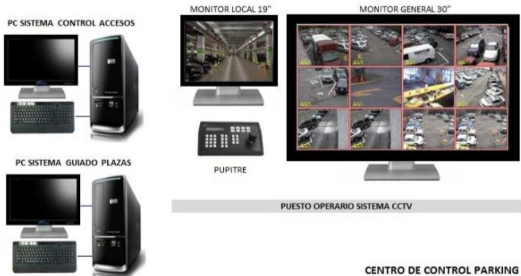
Figura 12.8. Esquema del centro de control.
