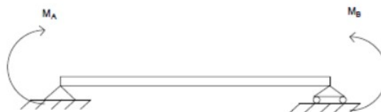
Figura 5.32. Barra I. Pórtico a estudio. Fuentes: Elaboración propia.
