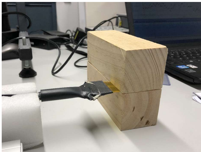
Figura 17. Colocación de las probetas del material asegurando un buen contacto.
