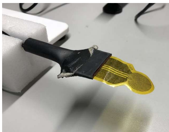
Figura 15. Espiral de níquel con recubrimiento protector de Kapton.
