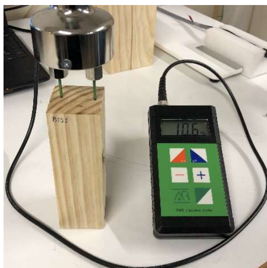
Figura 14. Medición de la humedad de una probeta.
