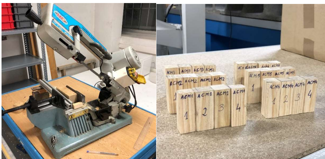
Figura 11. A la dcha. equipo utilizado para cortar las probetas cúbicas y a la izq. probetas obtenidas de las probetas cúbicas pertenecientes al tablón A.
