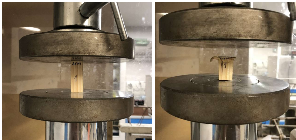
Figura 20. a) Probeta al comienzo del ensayo de compresión axial; b) Rotura de probeta en el ensayo de compresión axial.
