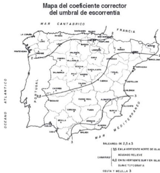
Figura 5.2. Coeficiente corrector umbral de escorrentía. (Norma 5.2-IC, 2016)
