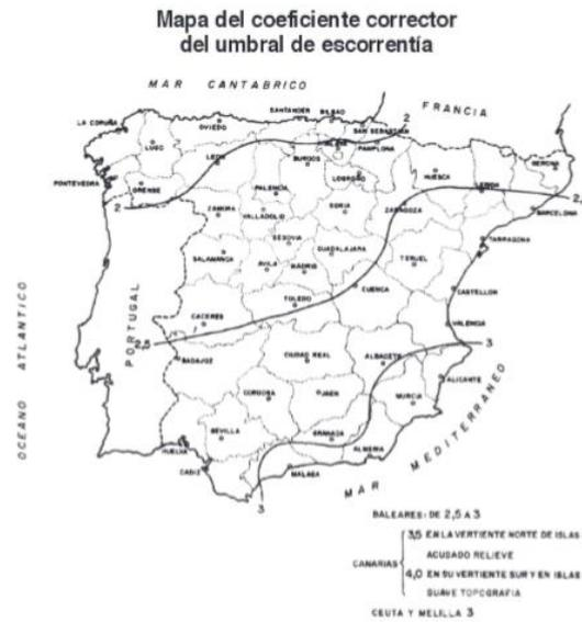
Figura 4.3. Coeficiente corrector umbral de escorrentía. (Norma 5.2-IC, 2016)
