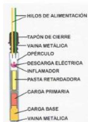
Imagen 3.7. Detonadores eléctricos. (Manual perforación y voladura, 2017)
