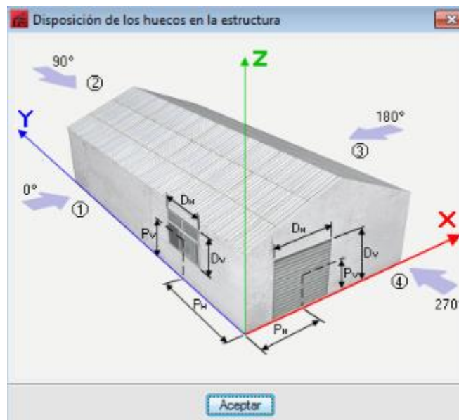
Fig. 31. Esquema de introducción de huecos
