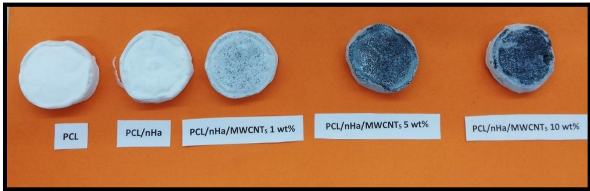
Figura 10: Andamios porosos fabricados.
