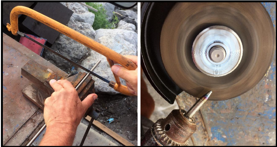
Figura 5.7: Proceso en el que se corta la varilla y se afila. Fuente: Elaboración propia.
