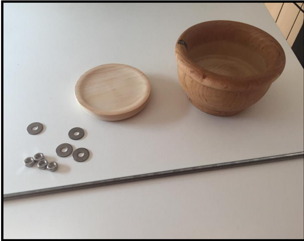
Figura 5.5: Varilla (después, gnomon y eje sobre el que se colocan las tuercas que actuarán de contrapeso), Plato de pulpo (después, Disco), Cuenco-recipiente (después, modificado para adaptarse a las medidas exigidas). Fuente: Elaboración propia.
