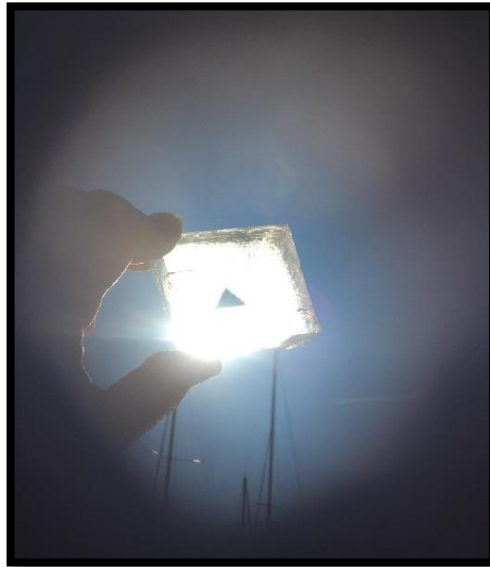
Figura 4.4: Espato de Islandia generando una única imagen, al dirigirlo directamente al sol. Fuente: Elaboración propia.
