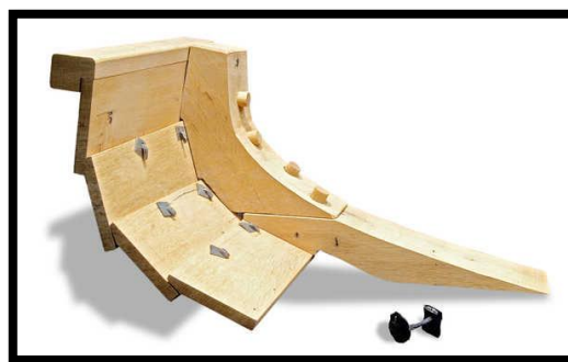
Figura 3.3: Ejemplo de casco trincado o tingladillo. Fuente: López, 2009.
