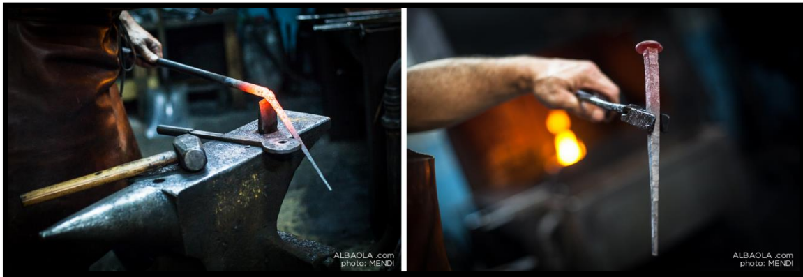
Figura 3.6: Fabricación de clavos para la nao San Juan . Fuente: Albaola.
