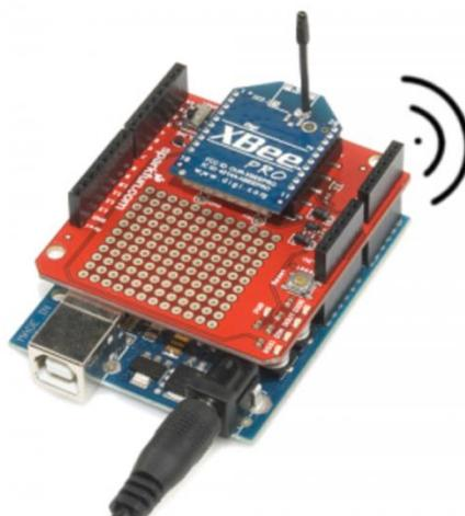
*Figura 6. 7 El Arduino acoplado a la SparkFun*
