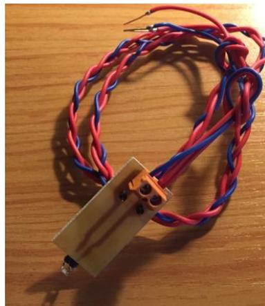
Figura 6. 2 PT100 con la configuración a 3 hilos
