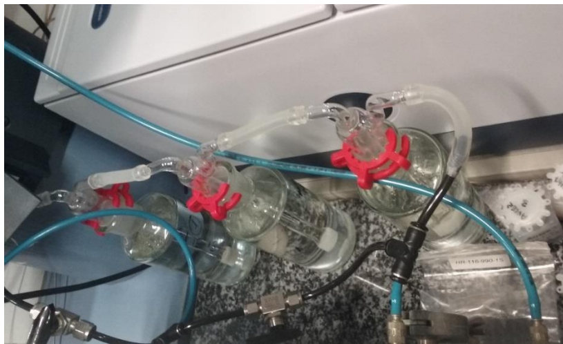
Irudia 11. Urez betetako botilak, TGA-ra nitrogeno hezea sartzeko.
