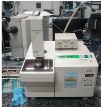
Irudia 10. TGA. Ezkerretik eskumara: Krisolak jartzeko atala, TGA osorik, gas emariak erregulatzeko gurpilak.
