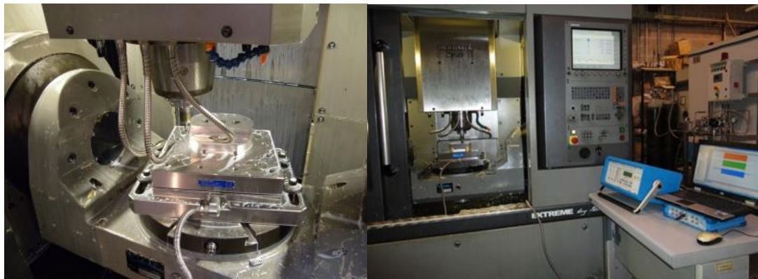
Figura 5. 12 Centro de mecanizado, mesa dinamoétrica, amplificador y analizador de señales
