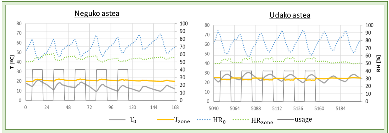
Irudia B. 10 Kanpo eta barne temperatura eta RH erabilpenaren arabera (a) urtarrileko eta (b) abuztuko aste batean
