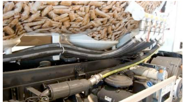
Fig. 14. Detalle de camión de suministro de pellet por impulsión neumática.
