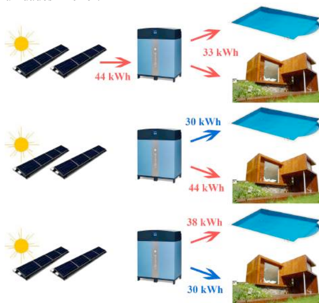
Fig. 25. Procesos de carga, calefacción refrigeración de un reactor Climate Well 10 de un barril. Fuente: Manual de ClimateWell™ Frío Solar, www.climatewell.com
