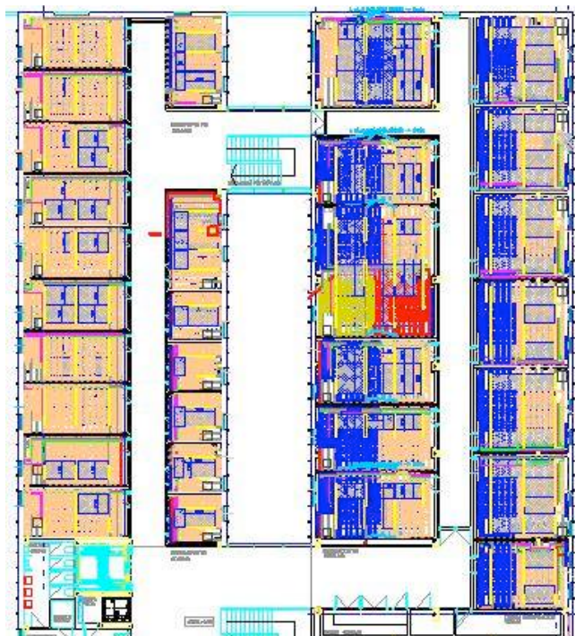
Fig. 38. Plano de distribución de zonas, circuitos y trama capilar en Conservatorio de Navarra.
