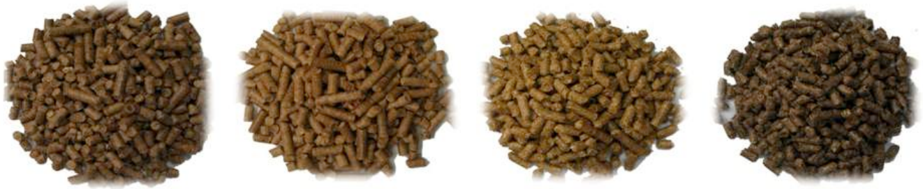
Fig.9. Pellets provenientes de residuos forestales y cultivos energéticos. De izquierda a derecha: pellets de mezcla de maderas, pino, brásica y chopo.
