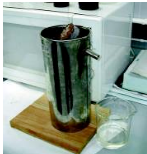
Fig. 6. Sistema usado para la determinación de la densidad por el método de la parafina.
