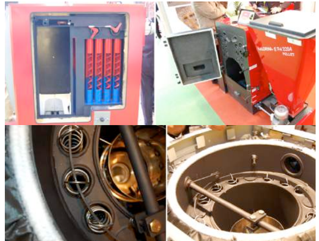
Fig. 22. En la parte superior, limpieza de tubos con sinfines helicoidales, izquierda, y palancas, derecha. En inferior, limpieza de tubos con muelles.
