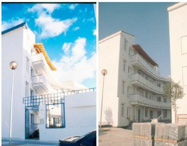
Fig. 6. Adecuación volumétrica de bloque de viviendas, fachada captora a mediodía, soleada en invierno y sombreada en verano. Arq. M. de Luxán, F. de Celis, E. Echevarría, F. Da Casa. S. Pedro de Alcántara. Fuente: Fotografías. M. de Luxán.
