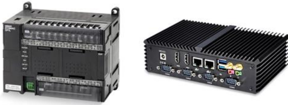
Fig. 9 PLC (izquierda) y PC industrial (derecha)
