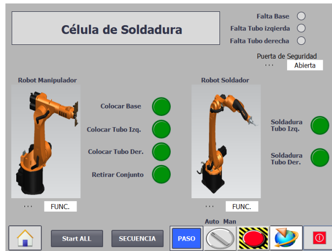
Fig. 48 Pantalla célula de soldadura robotizada
