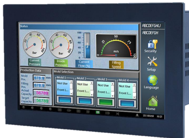
Fig. 10 Ejemplo panel operador HMI
