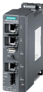
Fig. 51 Tarjeta SIMIT Unit PN 128
