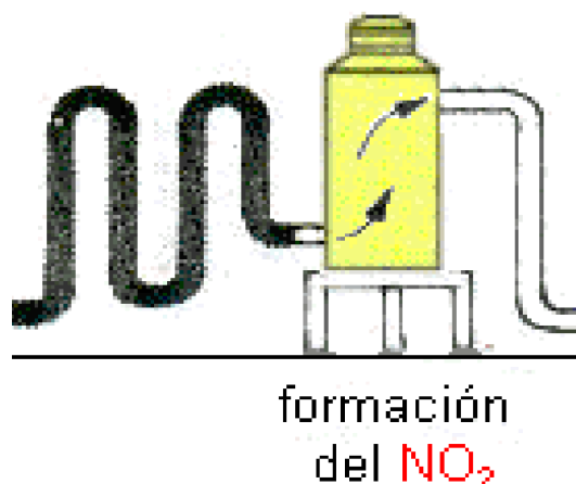
Ilustración 23: Esquema de la oxidación del nitrógeno monóxido.
