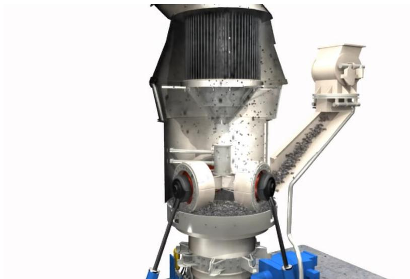
Además, los gases calientes que se dirigen hacia arriba secan el material molido y arrastra hacia la parte superior del molino al material triturado cuyo tamaño es el deseado (el polvo de gran finura asciende con facilidad), sin embargo, el material más grueso y que requiere molienda adicional vuelve a la mesa rotatoria. Finalmente, la harina deseada sale por la parte superior del molino.
