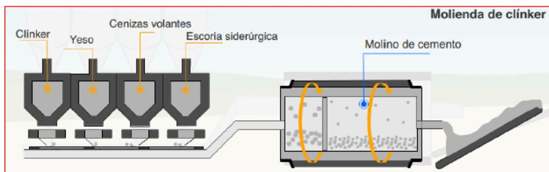
**Ilustración 11.** Descripción molienda de cemento (Fuente: IECA)
