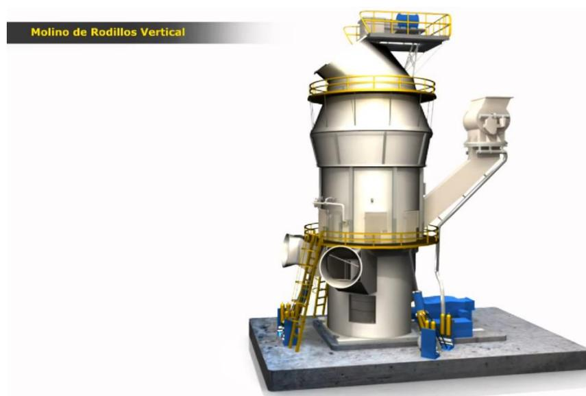
**Ilustración 3.** Molino de rodillos vertical
