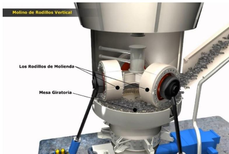
Ilustración 4. Funcionamiento proceso molienda rodillos
