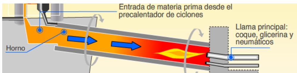
Ilustración 9. Horno rotatorio (Fuente: IECA)
