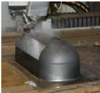
*Figura II-28: Eliminación capa Alfa mediante WJ.*
