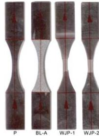
Figura II-44: Probetas de fatiga, Pulidas (P), granalladas, y tratadas por WJ.
