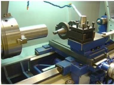
Figura II-15: Set-up experimental para torneado asistido por ultrasonidos.
