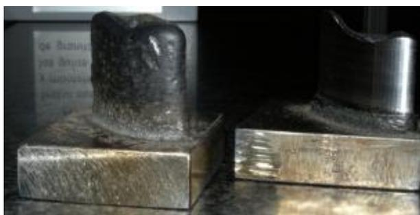
Figura II-23: Deposición de Inconel 718 mediante láser.
