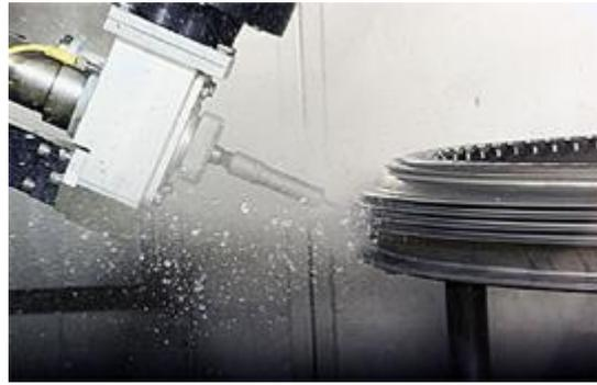
*Figura II-29: Decapado mediante WJ*
