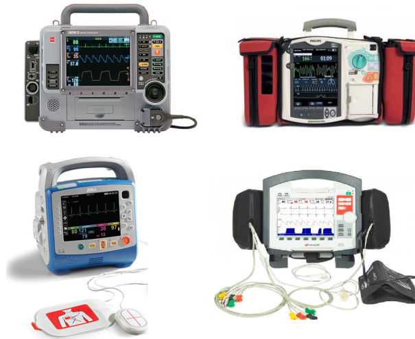
Figura 1.10. Cuatro diferentes modelos de monitores-desfibriladores de distintas marcas. De izquierda a derecha y de arriba abajo: Lifepak 15 (PhysioControl), Heartstart MRx (Philips), X-Series (Zoll) y Corpuls3 (Corpuls).
