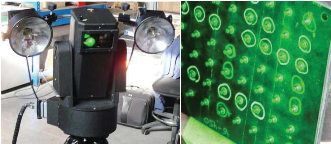
Figura 3.2.4. Izquierda: cabezal de shearografía con excitación por lámparas halógenas integrado. Derecha: proyección de luz coherente sobre probeta remachada.
