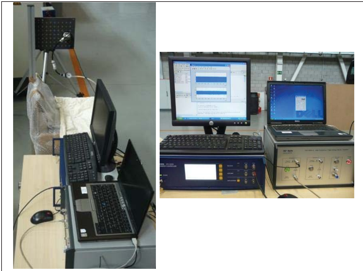
Figura 3.5.4. Izda: vista general del montaje experimental. Dcha: adquisición de datos, controlador del cabezal del vibrómetro láser, generador de funciones y amplificador.
