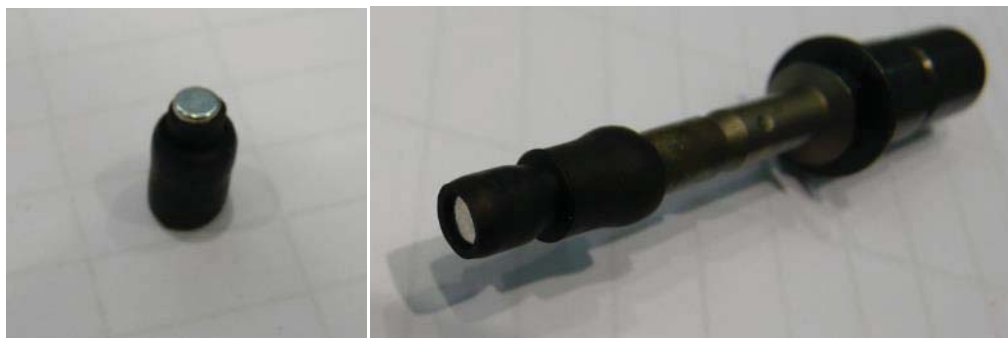
Figura 4.2.1. Izda: imán diametral sobre soporte elástico. Dcha: montaje del imán sobre la cabeza de cierre de un remache.
