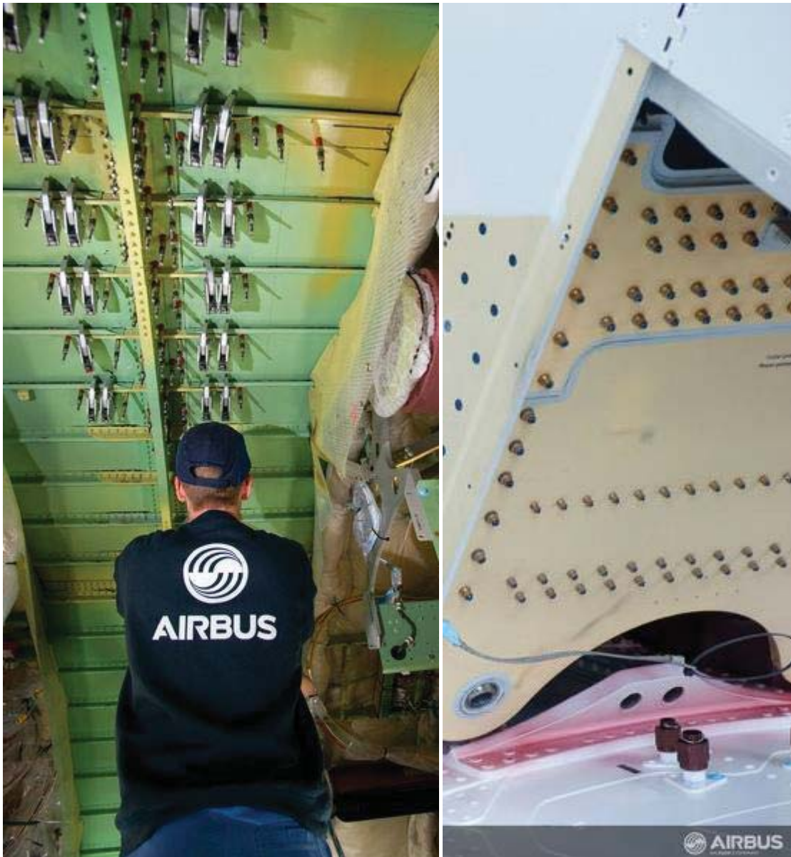
Figura 1.2.2. Izda: fabricación de una unión remachada mediante proceso manual. Dcha: detalle de roscas de remaches en componente aeronáutico.
