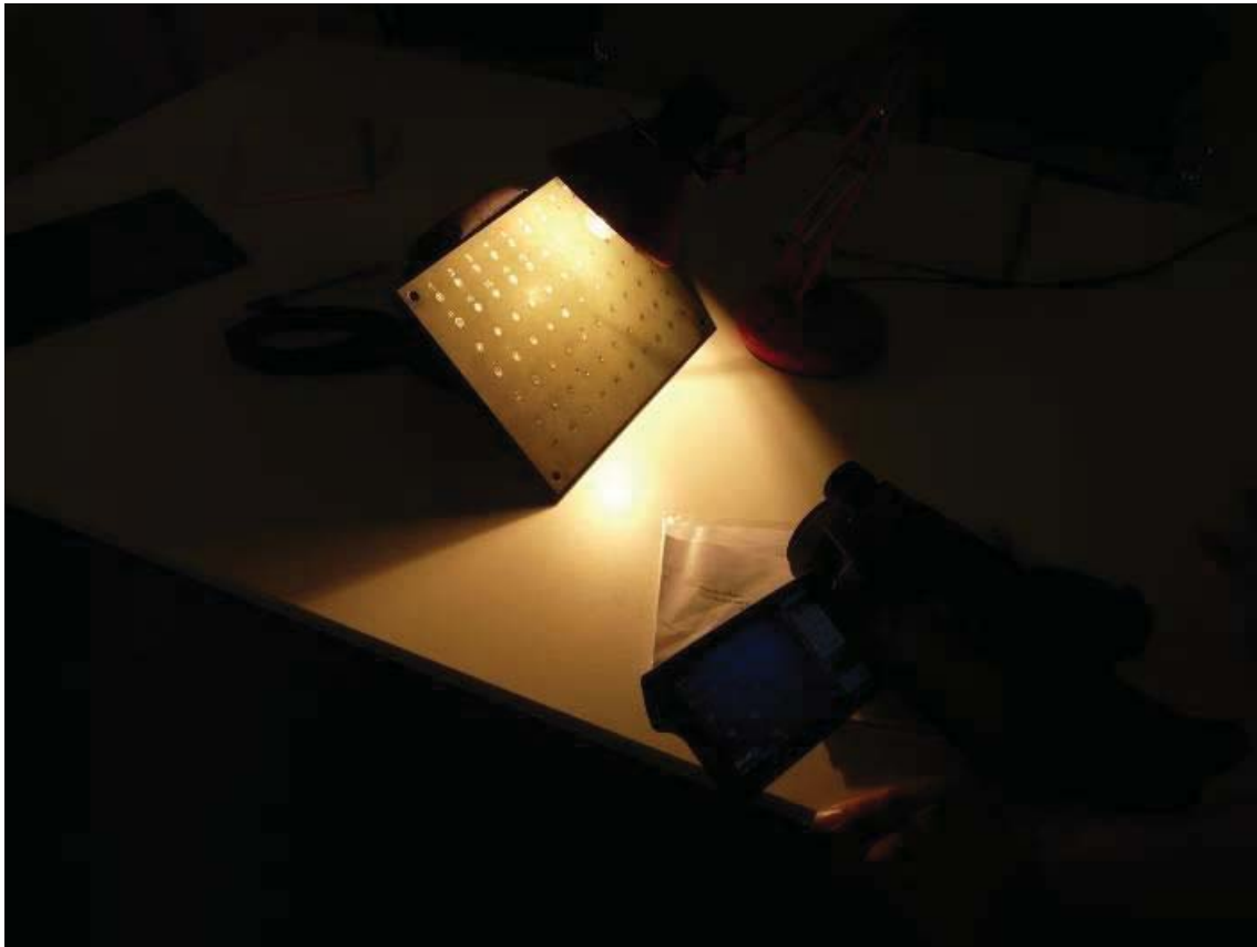
Figura 3.3.1. Calentamiento de la muestra #2 mediante lámpara halógena.
