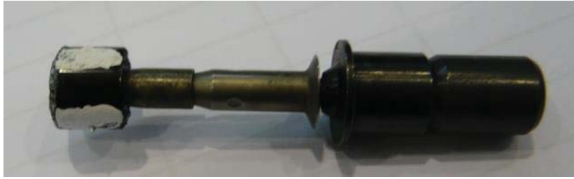
Figura 4.2.2. Montaje de un soporte con marcas reflectantes para el uso de un tacómetro óptico.
