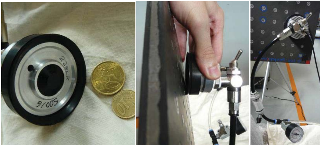
Figura 3.5.1. Izquierda: excitador piezoeléctrico con montaje por vacío. Centro y derecha: ejemplo de montaje del excitador sobre una probeta remachada.
