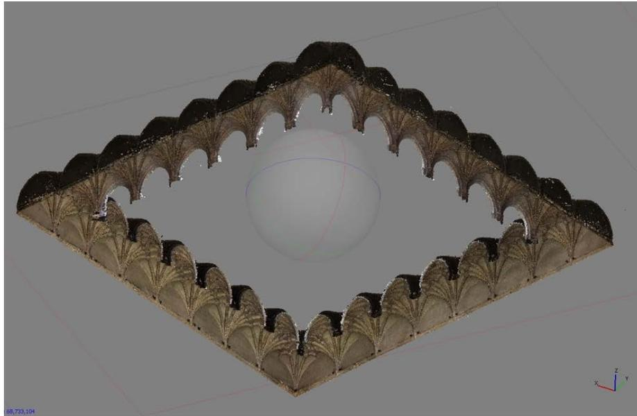
Fig. 36.- Nube de puntos densa correspondiente a las bóvedas del claustro (vista desde abajo).
