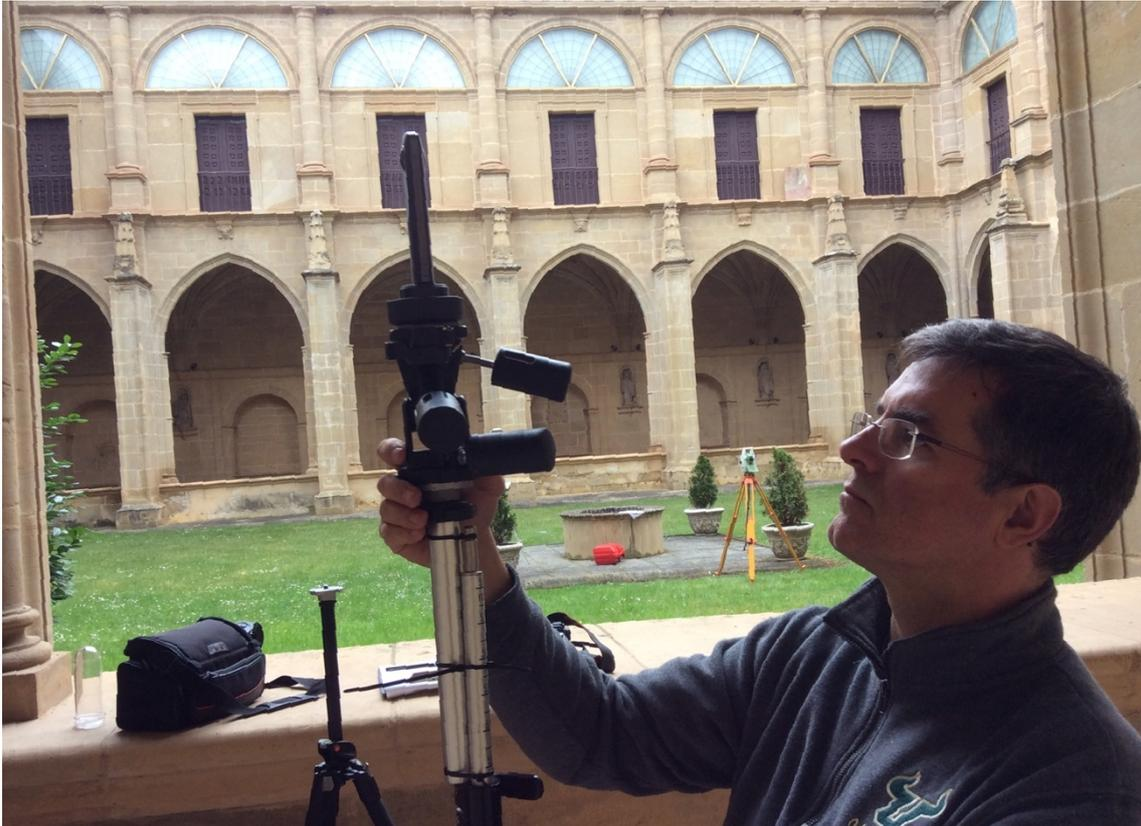
Fig. 9.- Montaje de la cámara panorámica sobre trípode para la captura de imágenes.
