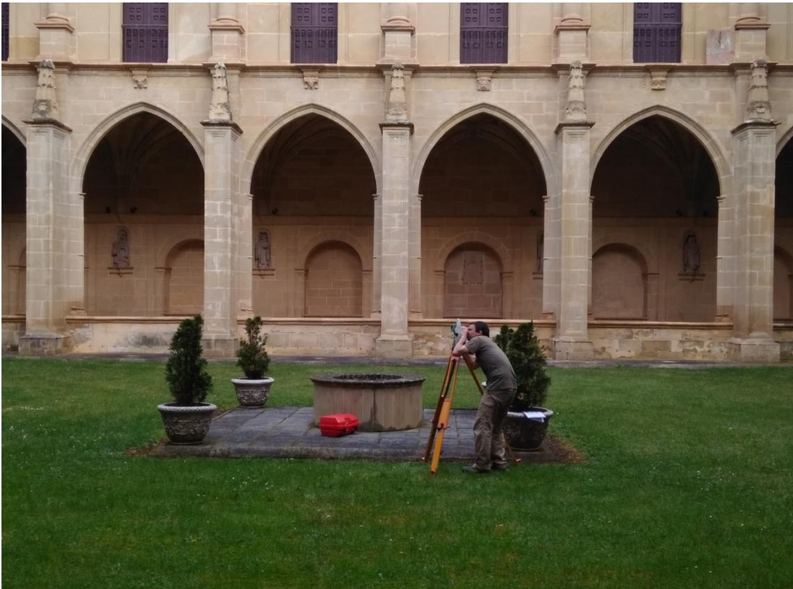
Fig. 4.- Medida –con estación total- de puntos destacados en las fachadas exteriores del claustro.
