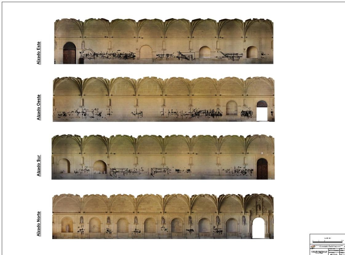
Fig. 45.- Conjunto de alzados con los grafitos superpuestos.
