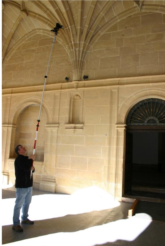
Fig.6.- Toma de fotografías con la cámara situada sobre un jalón telescópico con el objeto de salvar las zonas ocultas por la imposta.
