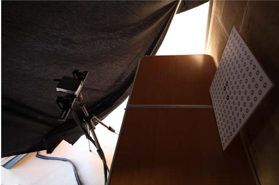
Fig. 17.- Calibración en campo del dispositivo de escaneado.
