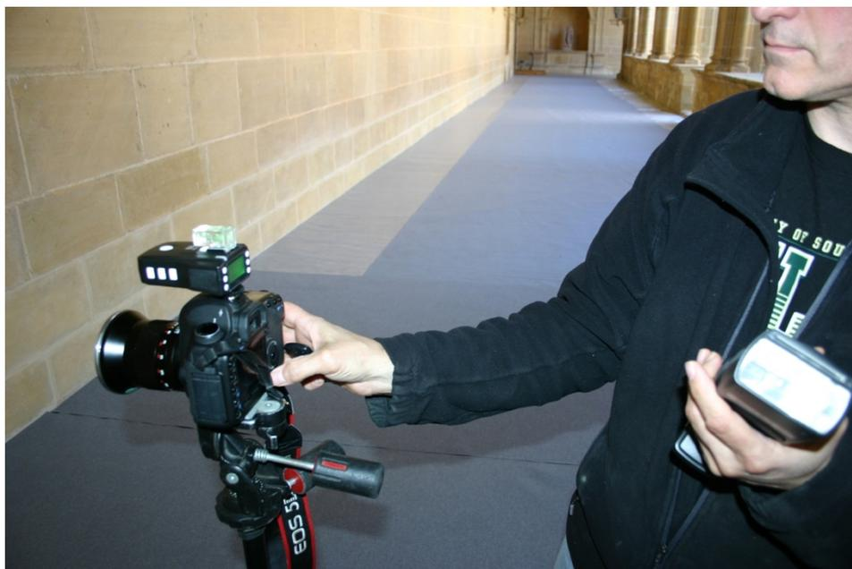
Fig. 13.- Pareja de flashes sincronizados utilizados en la captura de imágenes para RTI.
