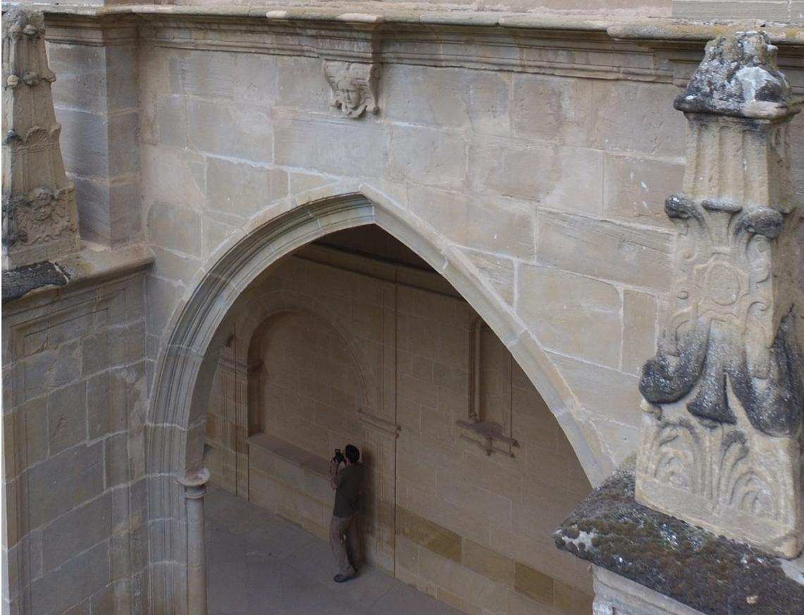
Fig. 8.- Captura de fotografías nadirales para el modelado de las bóvedas.
