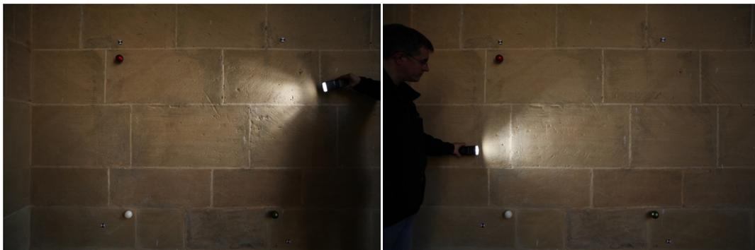
Fig. 15.- Ejemplos de imágenes individuales capturadas para la formación de una imagen RTI.
