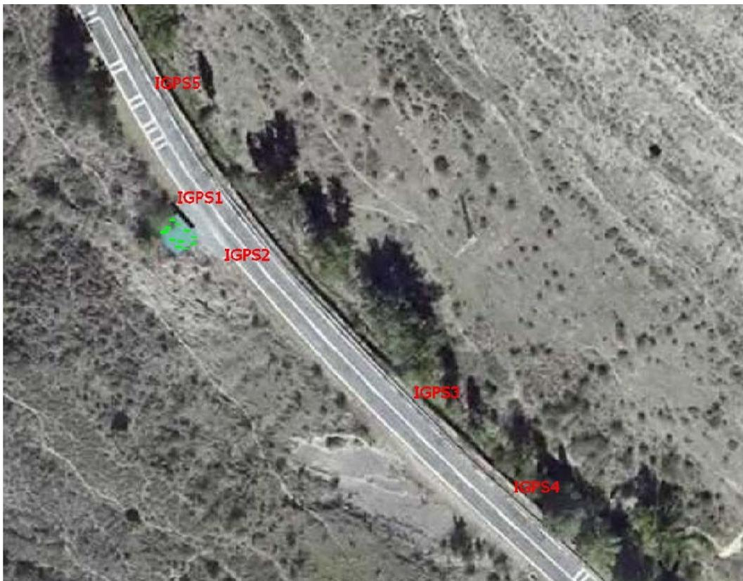
Fig. 5.- Situación de las bases que forman la red de referencias topográficas de este proyecto.
