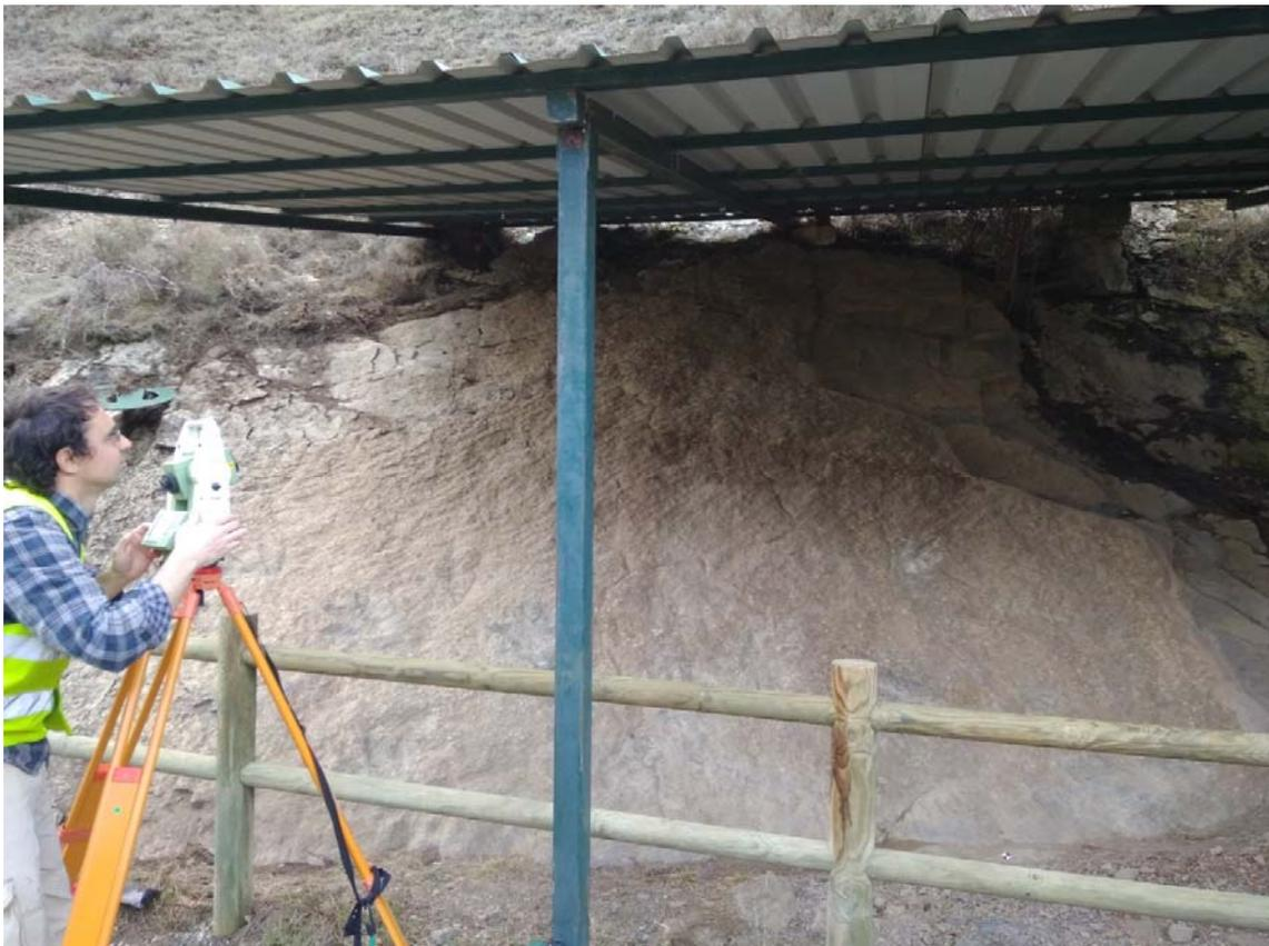
Fig. 6.- Medida con estación total de las coordenadas de los puntos de apoyo (dianas).
