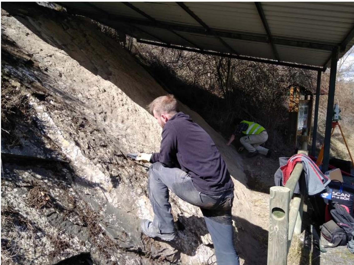
Fig. 3.- Limpieza del yacimiento y colocación de señales de referencia (dianas) para escalar y situar el modelo fotogramétrico.
