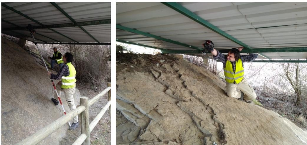
Fig. 8.- Toma de fotografías. A la izquierda, con la ayuda de un jalón, a la derecha, sujetando la cámara con la mano.
