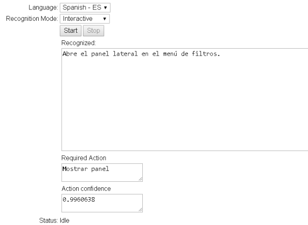
Figura 4.3: Prototipo del reconocimiento de voz y obtención de la intención asociada a la frase reconocida
