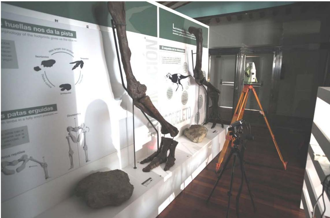
Fig. 3.- Medida con estación total de las dianas que forman la red topográfica.
