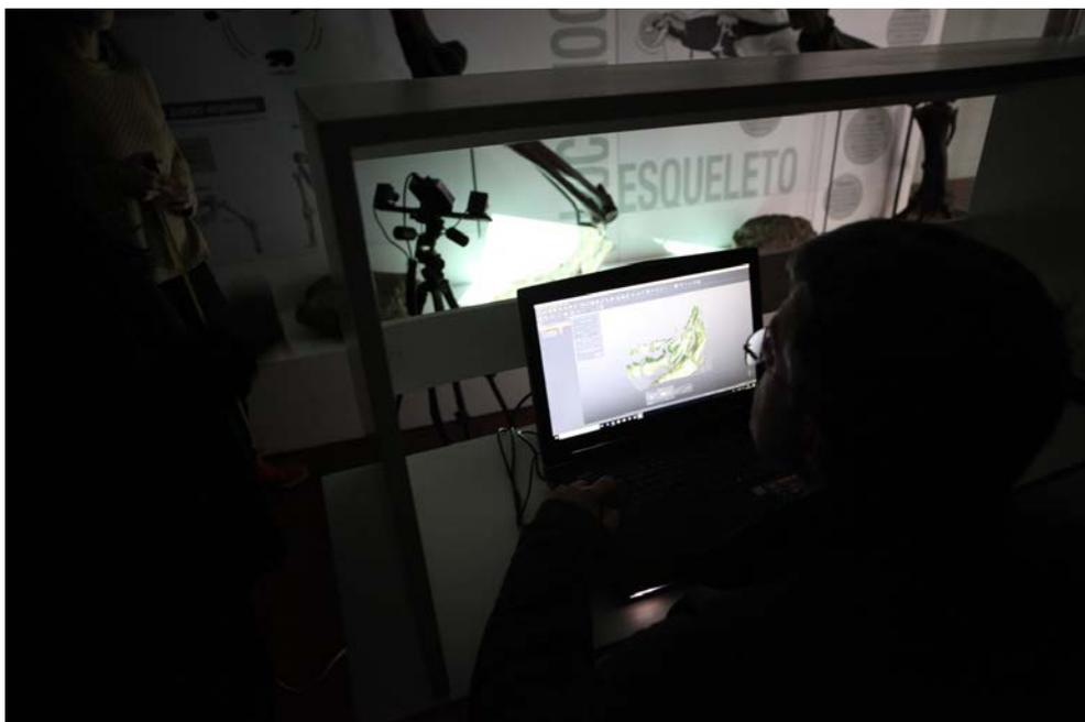
Fig. 6.- Procesado de las nubes de puntos durante su registro mediante su alineación para ir comprobando las zonas a recubrir en los siguientes escaneos.
