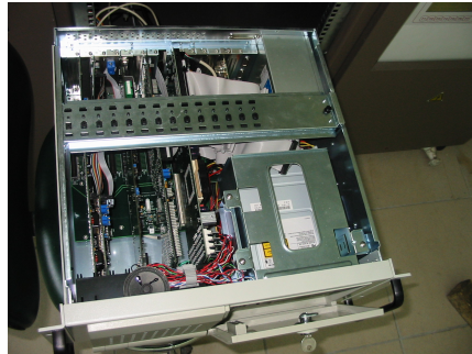
Figura 5.8: Interior del ordenador de control. Pueden verse las múltiples tarjetas que controlan los distintos componentes del difractorómetro.
