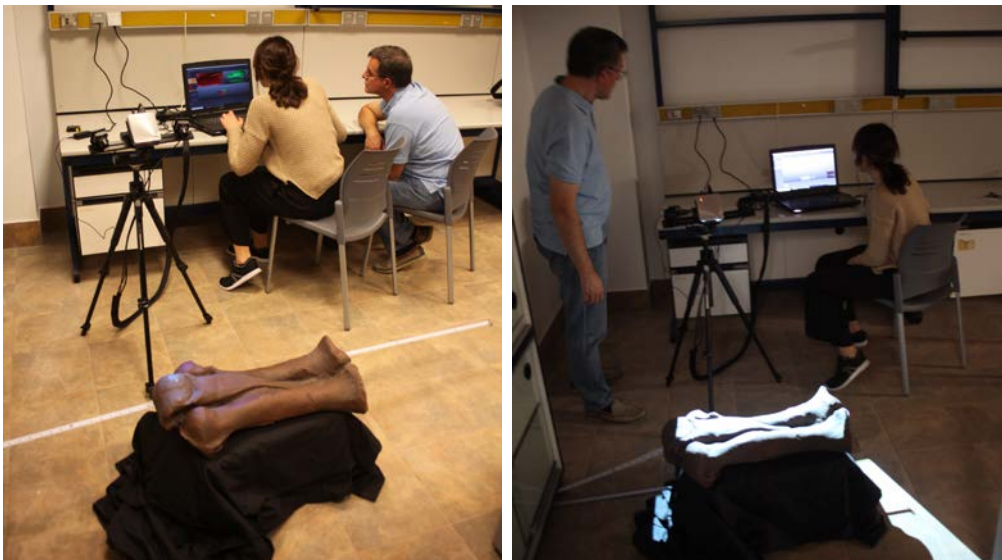
Fig. 2. Dos momentos del registro mediante escáner de luz estructurada. A la izquierda, alineando las nubes de puntos resultantes del registro y a la derecha el momento del registro de la nube de puntos.
