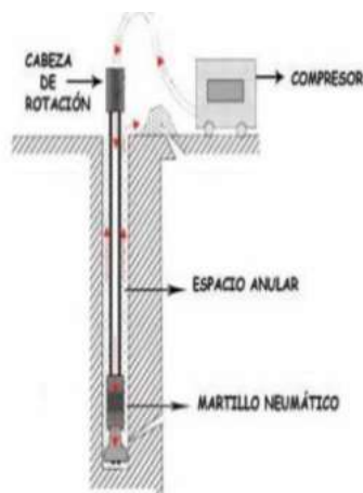
Ilustración 33. Método de perforación rotopercusión neumática con martillo de fondo
