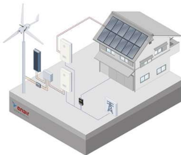
Ilustración 25. Instalación híbrida eólica-fotovoltaica
