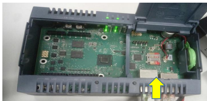
Figura 13: Inserción de la micro SD en el IOT
