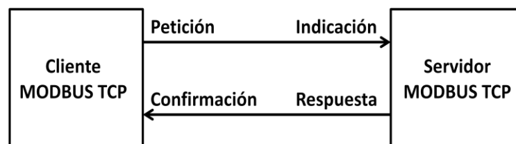
Ilustración 23. Comunicación cliente/servidor en Modbus/TCP
