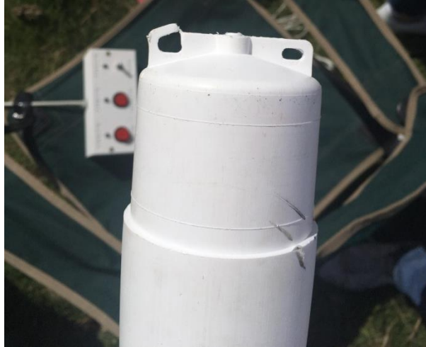
Figura 116. Detalle de la pestaña rota de la ojiva.
