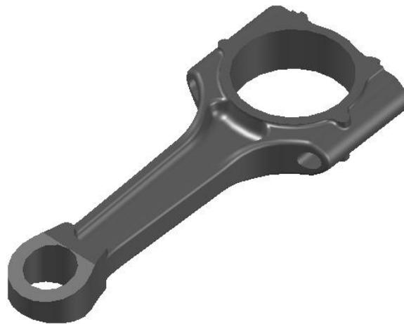
*Figura 7: Modelo CAD de la biela*
