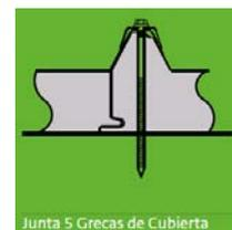
Figura 28 Detalles del panel de cubierta.
