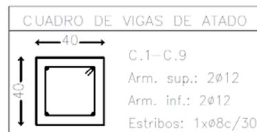
Tabla 5 Dimensiones y armados de zapatas y vigas de atado.
